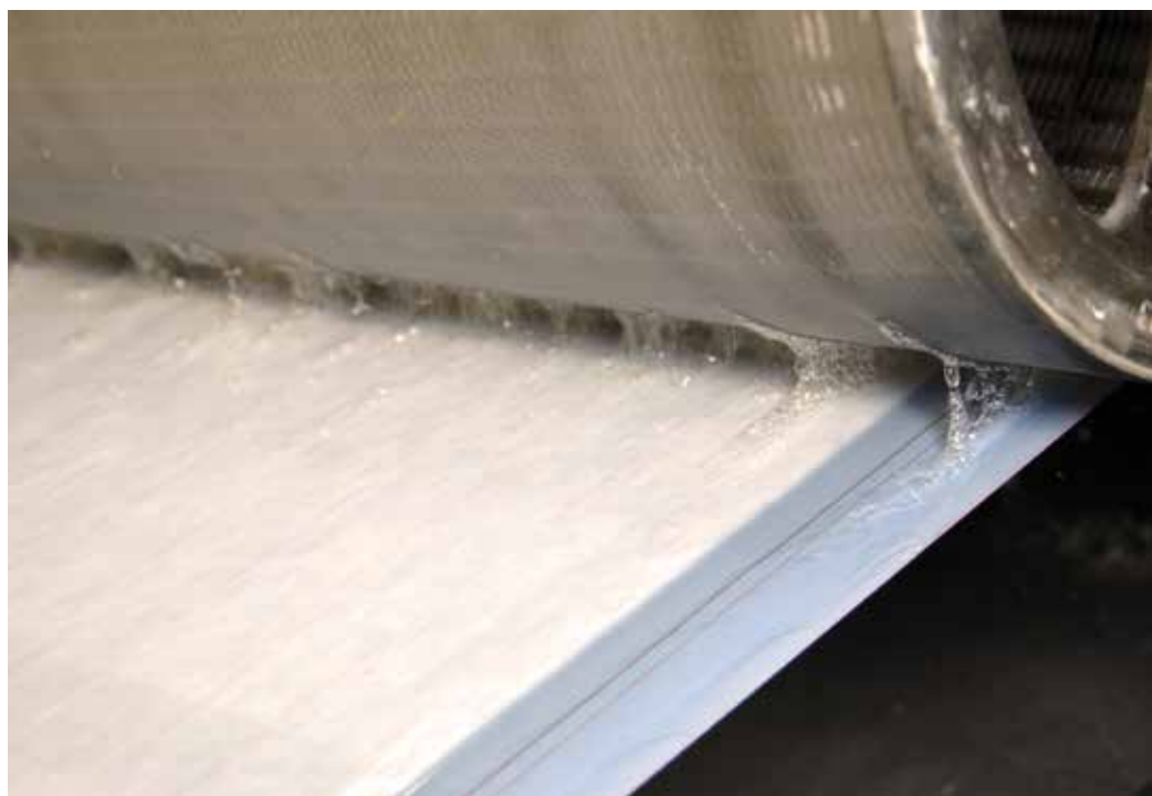
Der Egoutteur verleiht dem Papier eine gerippte Struktur.
